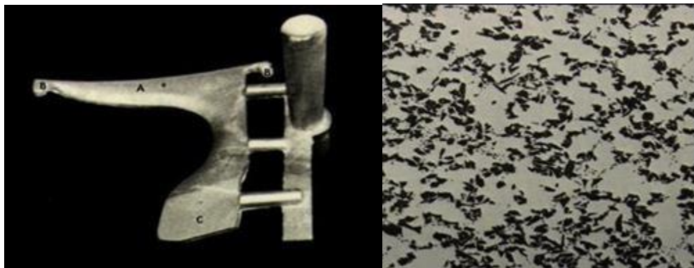
Figura 1: Pieza de compuesto y microestructura mostrando la distribución del refuerzo en la matriz
