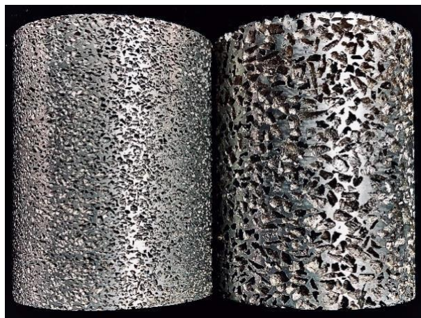
Figura 1: Ejemplo de espumas metálicas de celda abierta en dos tamaños de celda diferentes.
