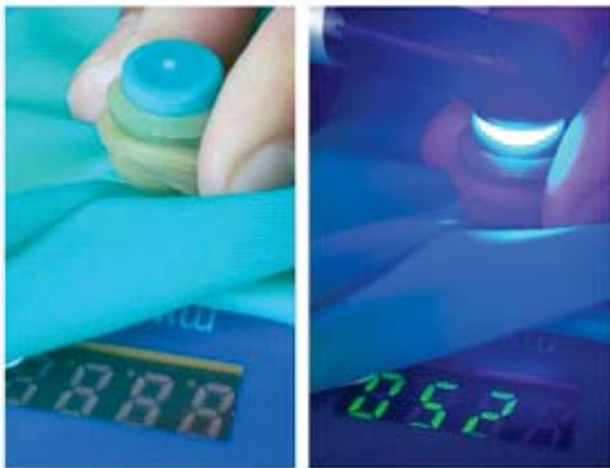
Figura 1.- Se muestra los especímenes antes y durante el paso de luz, registrándola en un radiómetro
