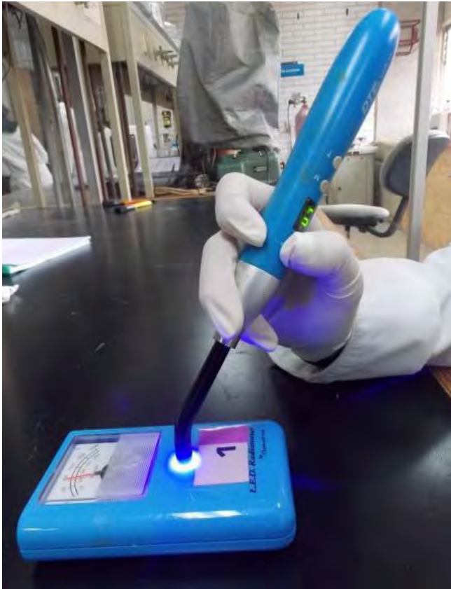
Figura 3. Medición de la intensidad de la Unidad de Fotocurado.
