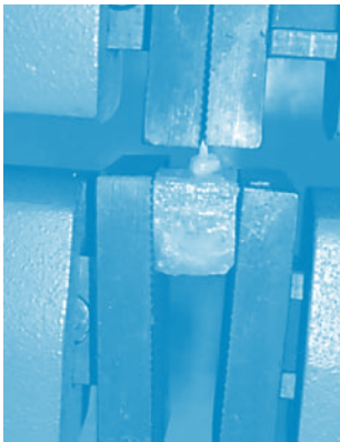
Fig. 7.- Máquina Instron para ejercer tracción sobre los postes colocados.
