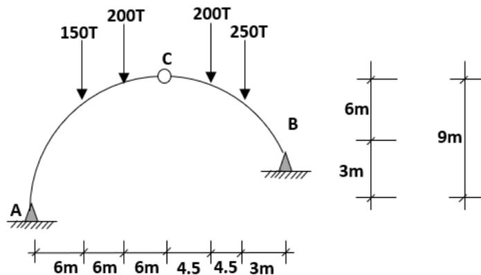
**Ejemplo de equilibrio 2:** Resuelva la siguiente armadura utilizando el método de NUDOS. Escriba el valor de las reacciones de los apoyos, las tensiones y compresiones para cada elemento en una tabla y/o sobre un dibujo generalizado
