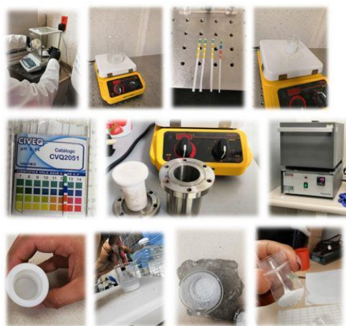
Figura 1. Síntesis hidrotermal de nanopartículas de \text{HfO}_2 a partir de precursores ( \text{HfCl}_4 y \text{NaOH} ).
