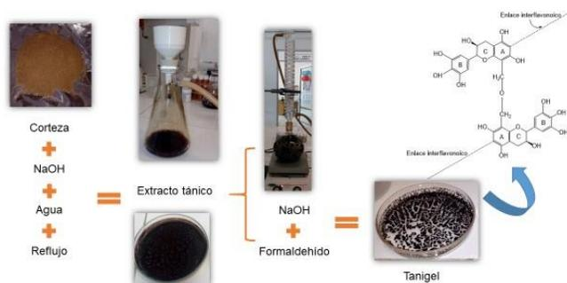
**Figura 2.** Preparación del tanigel y la estructura propuesta.
