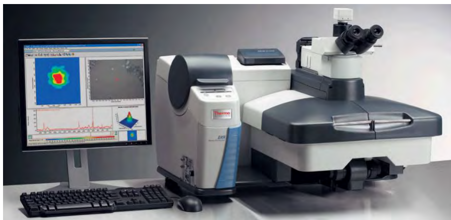
Figura 3. Microscopio Raman utilizado en este trabajo. Marca ThermoScientific, modelo DXR, equipado con láser verde de 10 mW
