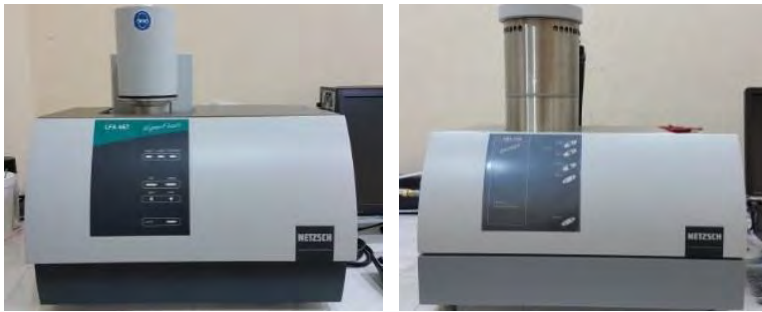
Figura 5. Equipos para medir propiedades termoeléctricas, izquierda: LFA 467 HyperFlash; derecha SBA 458 Nemesis (Netzch®).
