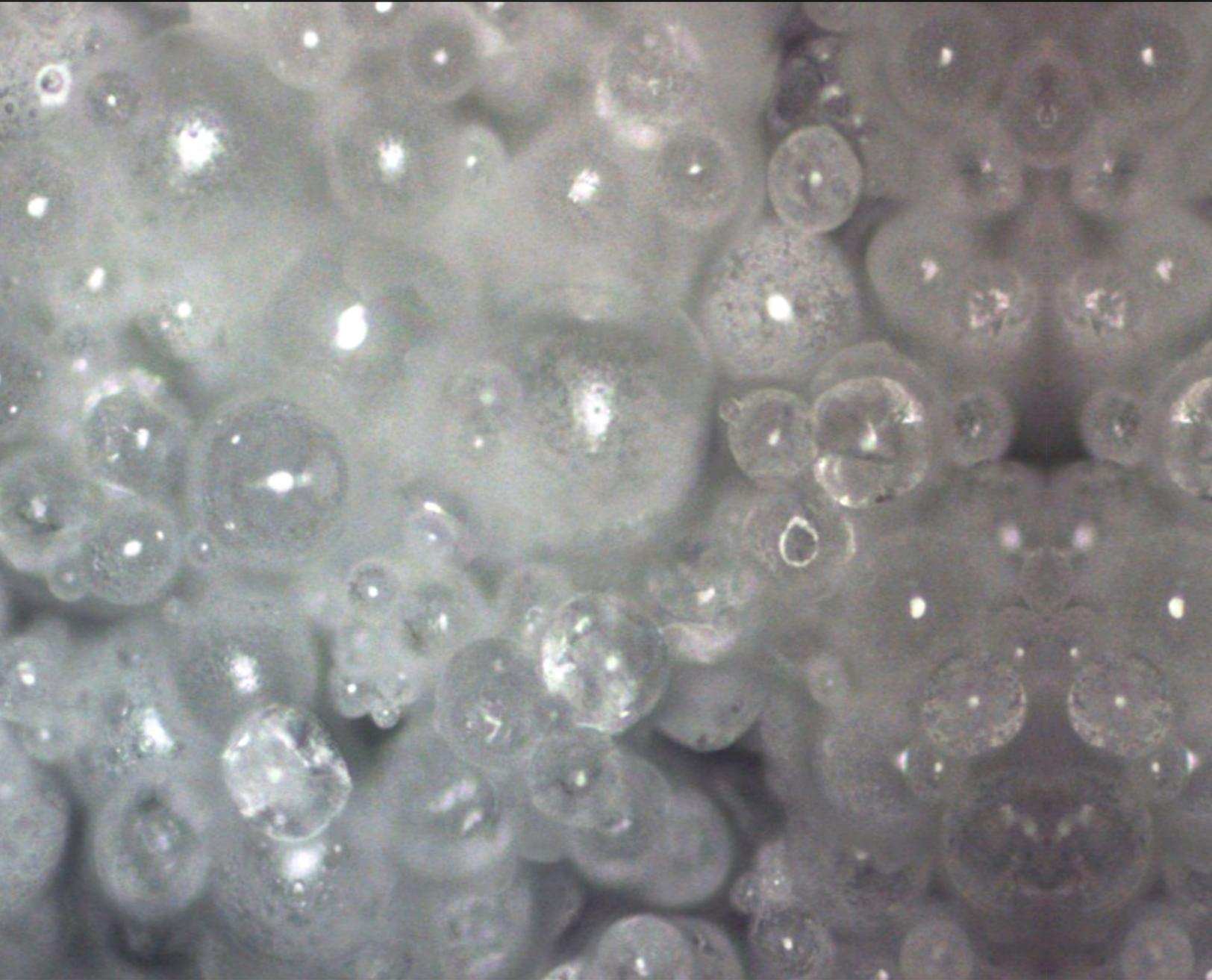
Imagen obtenida con microscopio Raman y por superposición de imágenes utilizando software especializado. Las microesferas son fabricadas de ácido láctico co-glicólico. Al tener en su interior algún medicamento, tienen potenciales aplicaciones en diversas áreas de la medicina.
