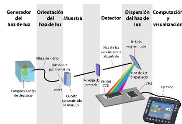
Figura 10. Esquema del funcionamiento de la técnica Uv-Vis. Observando la imagen, inicia de la parte izquierda con una lámpara de Xenón, la cual emite un haz de luz a la cubeta de cuarzo, esta cubeta contiene la muestra, la luz pasa mediante un detector, de ahí, se dispersa el haz de luz y por último, se visualizan los resultados en una Pc. [22].
