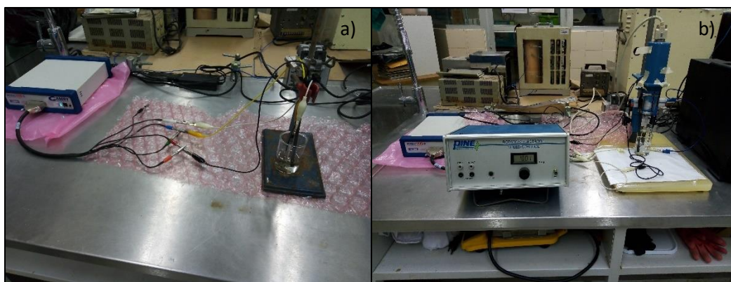
Figura 22. Montaje para pruebas en condiciones estáticas (a) e hidrodinámicas (b)
