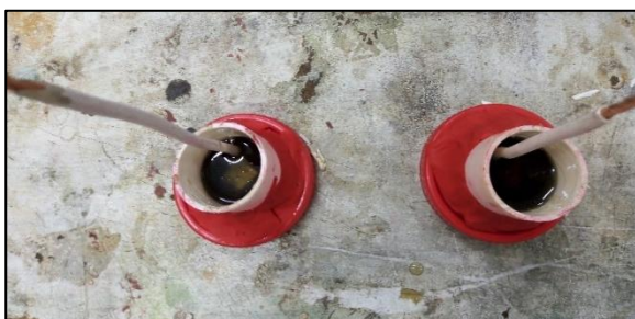
Figura 20. Montaje de las piezas metálicas en tubos de PVC
