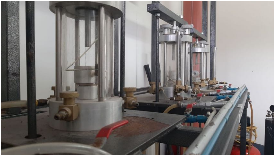
Figura 4. Medición de las propiedades mecánicas del suelo con la máquina triaxial.
