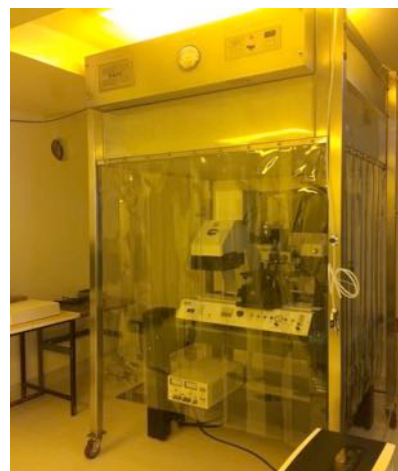
Figura 24. Campana de extracción y alineadora para procesos de fotolitografía del laboratorio LaMDDA.
