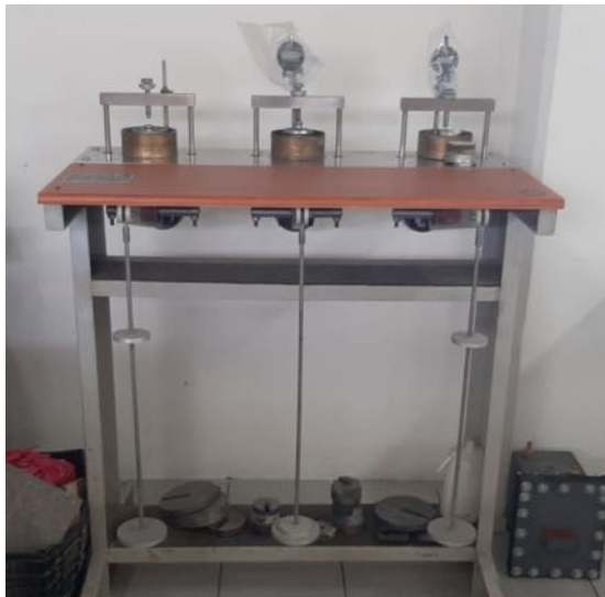
Figura 3. Aparatos de consolidación unidimensional para deformaciones de suelos y máquina CBR para medir la capacidad estructural de los suelos.
