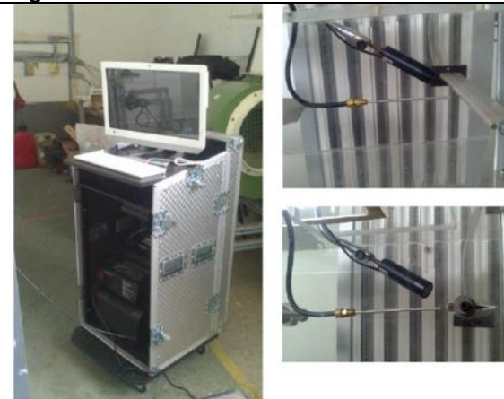
Figura 49. Kit de monitoreo de líneas de corriente en modelos aerodinámicos a escala.
