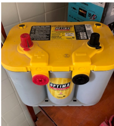
Figura 11. Batería de ciclo profundo.
