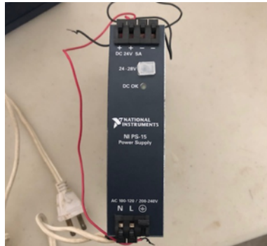
Figura 6. Fuente de alimentación que convierte corriente alterna 110 V a corriente directa 12 y 24 V.
