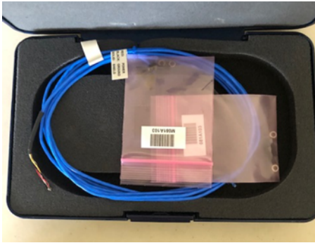
Figura 5. Acelerómetros tipo MEMS PCB modelo 3741B122G con una sensibilidad de 1V/g.
