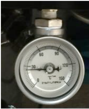
Figura 53. Termopar para medir la temperatura de flama.
