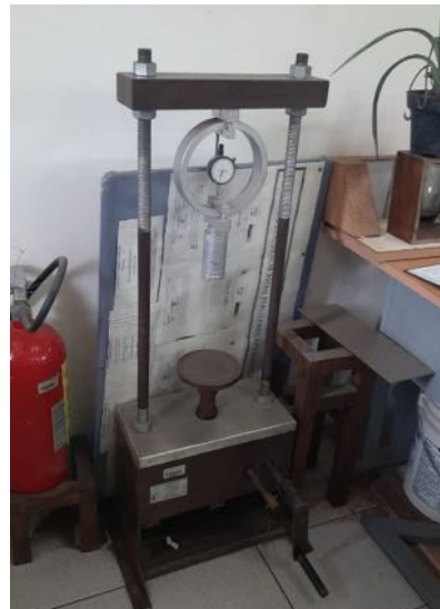
Figura 3. Aparatos de consolidación unidimensional para deformaciones de suelos y máquina CBR para medir la capacidad estructural de los suelos.
