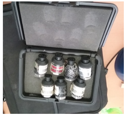
Figura 16. Acelerómetros uniaxiales piezoeléctricos de alta sensibilidad.
