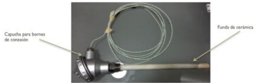
Figura 54. Termopar para medir temperatura de flama.
