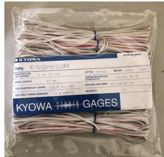
Figura 9. Galgas extensométricas para concreto.
