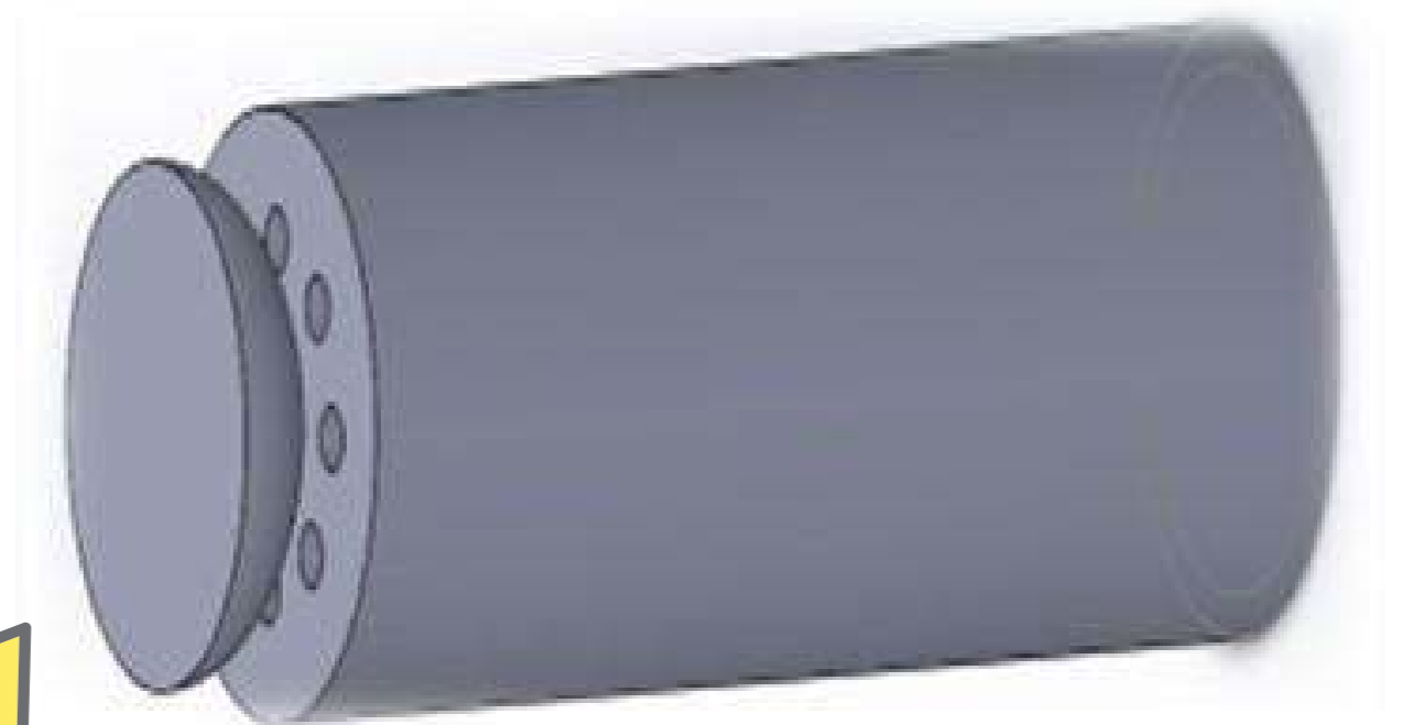
Figura 2. Bluff body colocado sobre el inyector de combustible.
