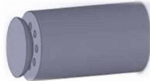
Figura 2. Inyector de combustible con bluff body.
