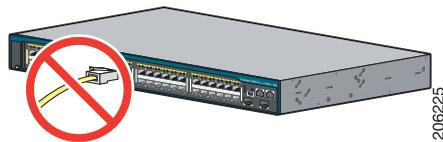
**Paso 2** Durante la configuración con Express Setup, el switch actúa como un servidor DHCP. Si el PC cuenta con una dirección IP estática, cambie temporalmente la configuración del PC para usar DHCP antes de continuar con el paso siguiente.
