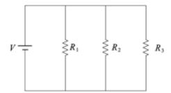
2. **Sin conectar la fuente**, mida con su multímetro en la escala adecuada (si no es autorango) la resistencia total en el circuito. Determine el error en la medición de acuerdo con sus cálculos. Anote estos valores en la tabla al final de este documento.
