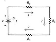
2. **Sin conectar la fuente**, mida con su multímetro en la escala adecuada (si no es autorango) la resistencia total en el circuito. Determine el error en la medición de acuerdo con sus cálculos. Anote estos valores en la tabla al final de este documento.
