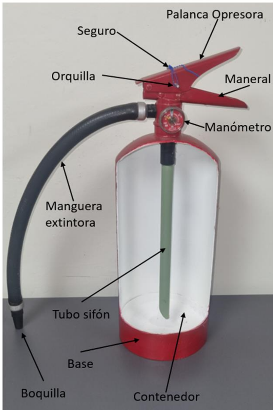
Imagen 1. Partes de un extintor
