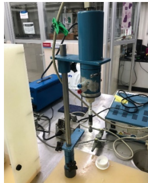
Electrodo cilíndrico rotatorio (RCE) con regulador de velocidad PINE
