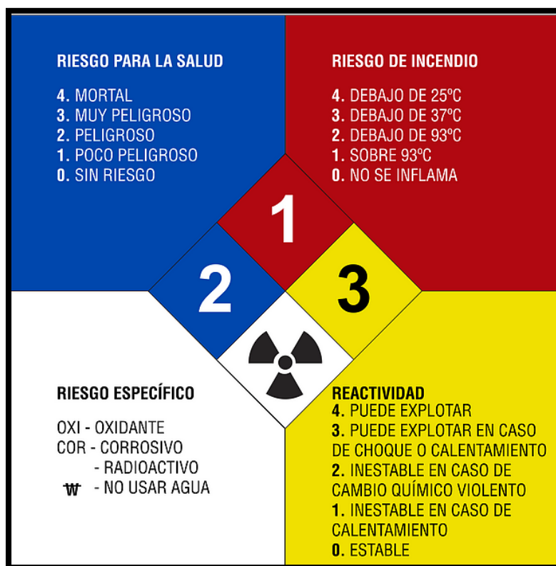
Figura 2. Rombo de materiales peligrosos de la NFPA. Fuente: Identification of the Hazards of materials for emergency response, páginas 29 y 30.
