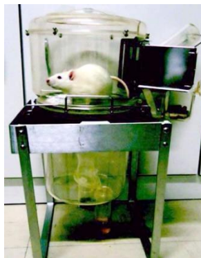
Figura 1. Colectores de orina simples y con detector automatizado.
