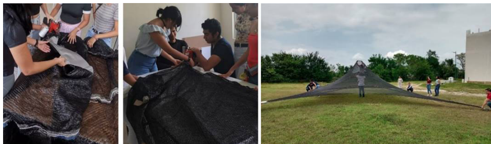
Figuras 32-34. Manufactura del patronaje de la malla sombra de invernadero
