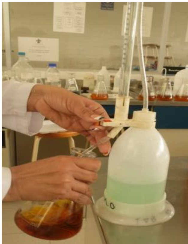
Figura. 10. Proceso de titulación en los dos sustratos y el duplicado
