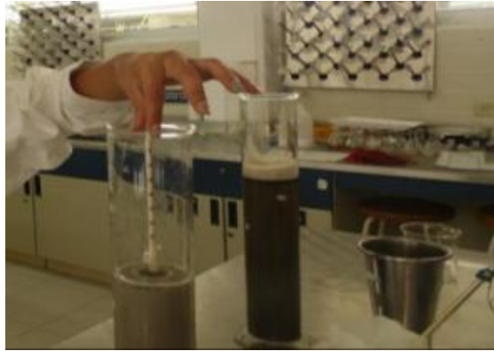
Figura 4. Colocación del densímetro de Bouyoucos en la probeta de 1000 ml
