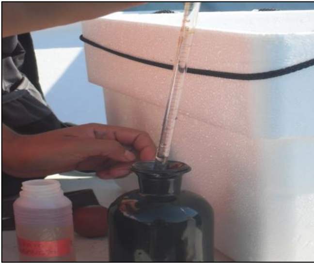
Figura 4. Fijación del Oxígeno disuelto por el método Winkler
