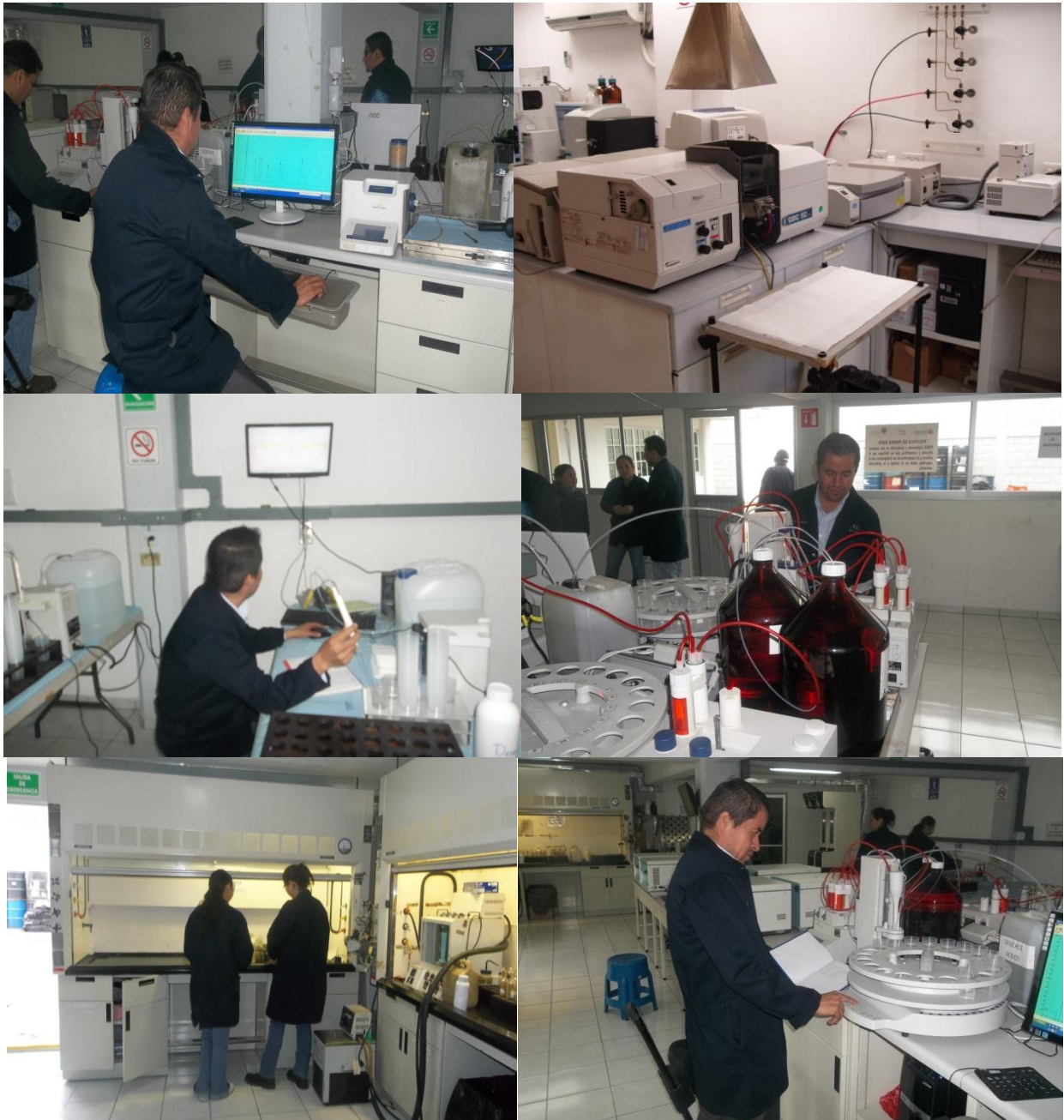
Figura 26. Laboratorio Mensuranda S.A de C.V._donde se analizaron las muestras mediante la técnica de espectrofotometría de absorción atómica.
