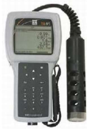
Figura 6. Medidor Multiparámetros HI 9829
