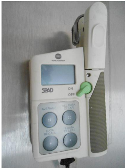
Figura 8. Medidor de clorofila (Spad 502)
