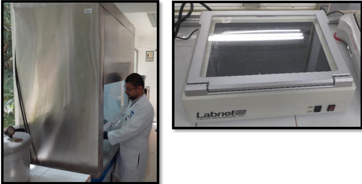
Figura 38. Campana de extracción y transiluminador
