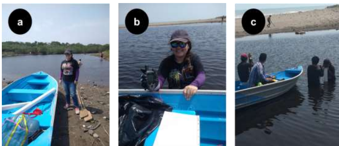
Figura VI. Trabajo de campo en el estero conectado a la playa Emiliano Zapata, ejido El Sacrificio, Tuxpan, Veracruz. a) Materiales para el muestreo. b) Localización de la coordenada mediante GPS. c) Extracción de los sedimentos contaminados con nucleador de PVC.
