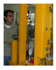
4) Nivelar el cabezal de carga y colocando a una distancia ligeramente mayor a la altura de la muestra.
