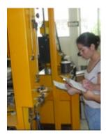
5) Se procede el ensayo considerando que finaliza cuando hay un retroceso en el medidor de deformación de cargas se dice que a fallado y se detiene el ensayo registrando un par de lecturas mas. O cuando se prolongue el tiempo hasta 8.00 min.
