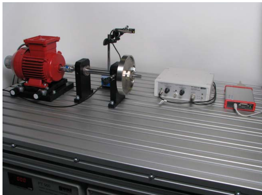
Fig. 6.2 Montaje para el ensayo: Equilibrado en un plano
