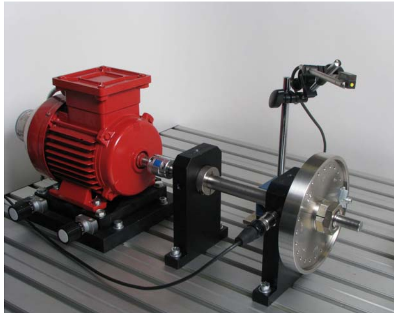
Fig. 6.3 Montaje para el ensayo: Equilibrado en un plano
