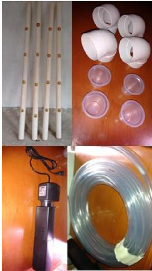
Materiales para la construcción del sistema acuapónico NFT
