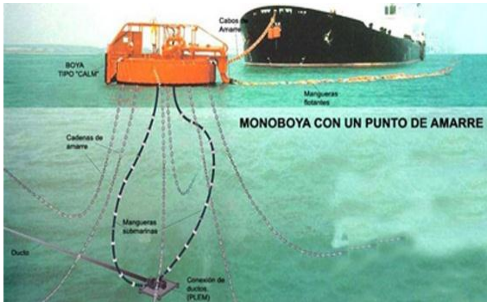
Figura 12- Buque amarrado a monoboya Tipo Calm, Fuente: SBM offshore, 2010.
