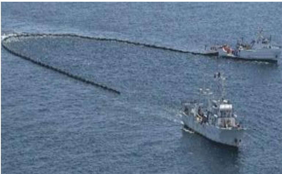
Figura 8.-Barrera de trampa para contención de hidrocarburos, se observa el área que sobresale del nivel de agua, Fuente: Castillo, 2012.
