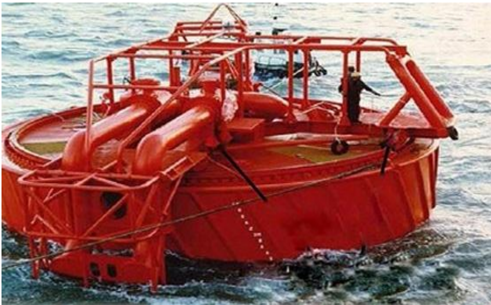
Figura 14 Plataforma giratoria con rodamientos inferiores, Fuente Imodco Calm Systems, 2008.
