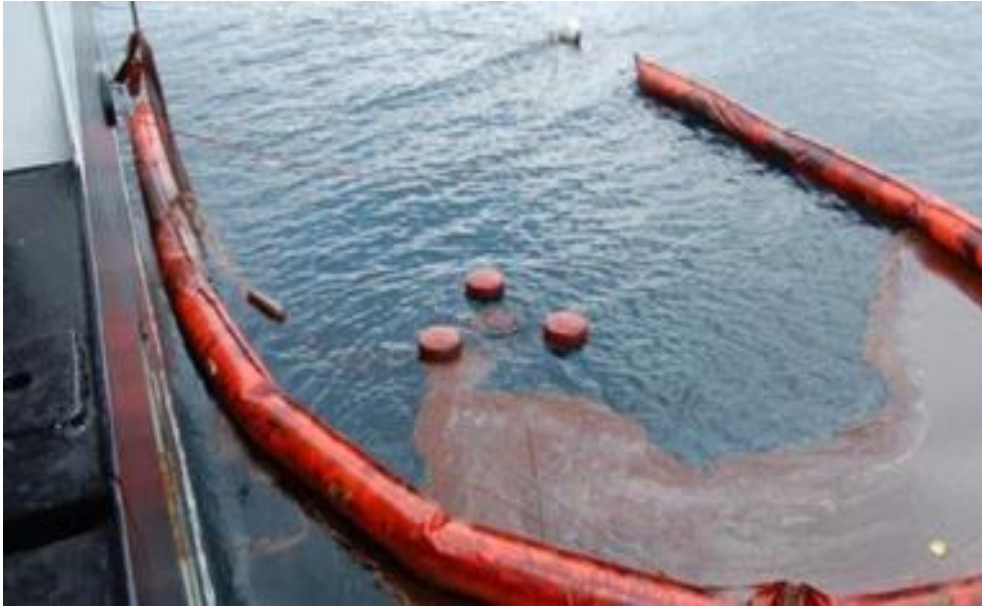
Figura 7.-Hidrocarburo recolectado por una barrera remolcada al costado de un barco. Fuente: Noaa, 2011.
