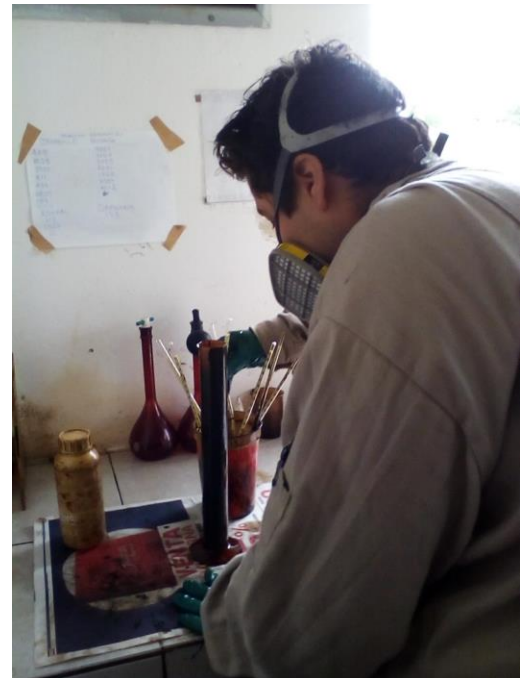
USO DE DENSIMETRO PARA OBTENER GRAVEDAD API
