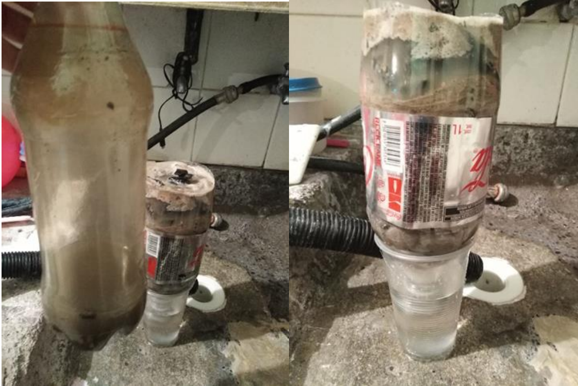
Imágenes 15 y 16. Construcción del filtro para agua como reto para el cambio. El agua es tomada de una presa.
