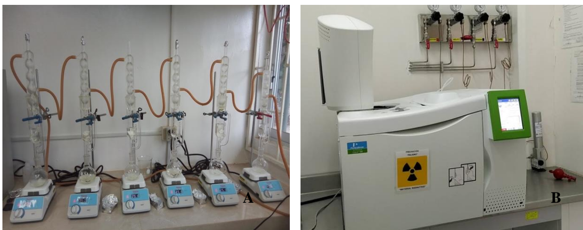
Figura 4. A) Equipos del método Soxhlet usados para la extracción de lípidos en muestras secas de huevos y paralarvas de O. insularis . B) Equipo de cromatografía de gases empleado para la identificación y cuantificaron los ácidos grasos.
