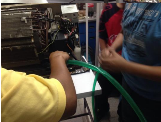
Fig. 1) Equipo de práctica en donde se puede apreciar la explicación en cómo se realiza el mantenimiento de un equipo de aire acondicionado. Se puede ver que el equipo está desenergizado, al momento de desatornillarlo para poder darle la limpieza. Podemos también apreciar el evaporador y las tarjetas de alimentación.
