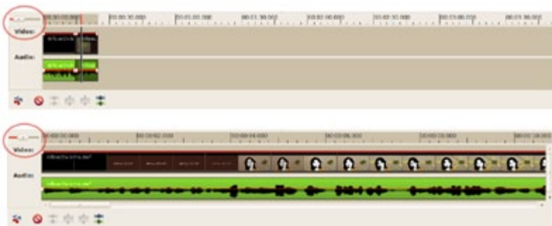
Con la herramienta de tamaño se puede hacer la secuencia más grande para realizar cortes con mayor exactitud
