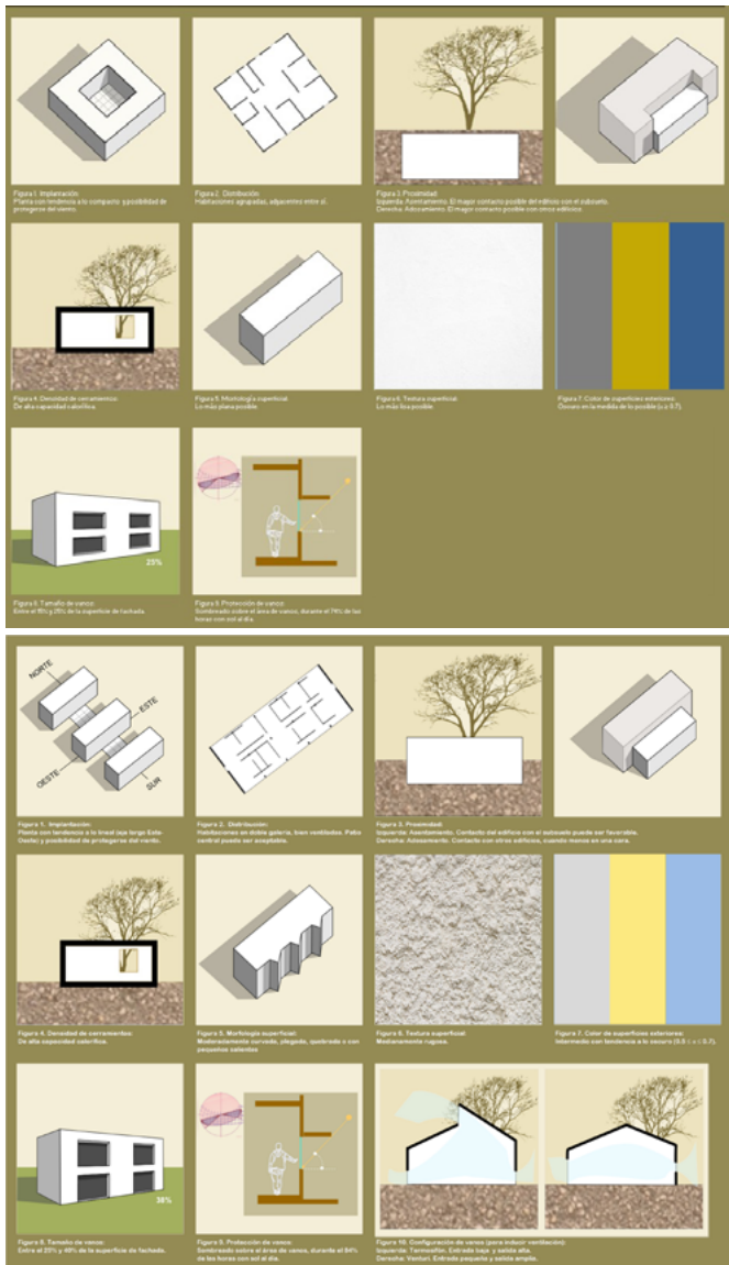
Figura 5.53. Esquemas demostrativos de las recomendaciones de bioclimatización para dos climas diferentes. Arriba: de condiciones principalmente frías (55%) y en segundo término neutras (45%) (Ciudad de México), Abajo: de amplia oscilación térmica con mayor presencia de condiciones neutras (53%) (Colima, México)
