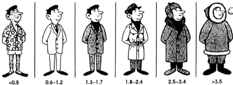
Figura 3.2. Aislamiento de diferentes conjuntos de vestimenta en unidades clo . Fuente: Auliciems y Szokolay (2007, pág. 9)
