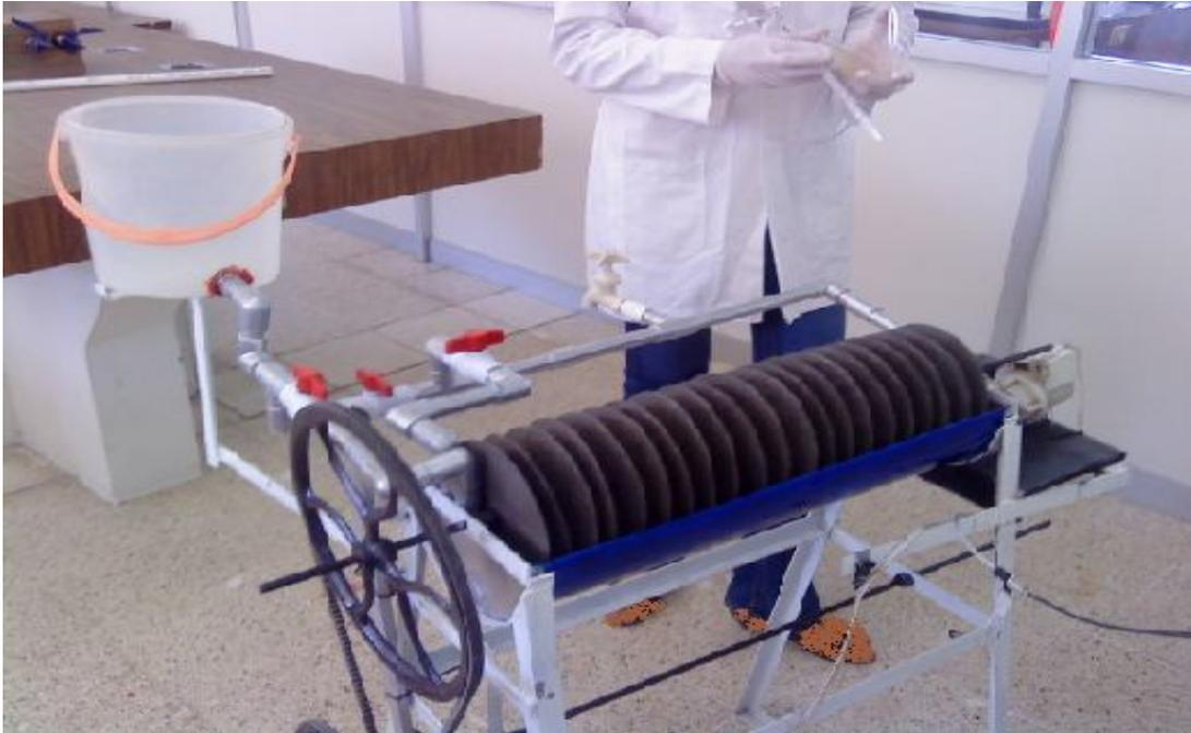
**Fig. 2.2** Bioreactor de tipo aerobio utilizado para la degradación del fenol.
