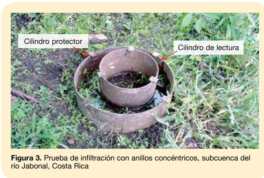
**Figura 3.** Prueba de infiltración con anillos concéntricos, subcuenca del río Jabonal, Costa Rica
