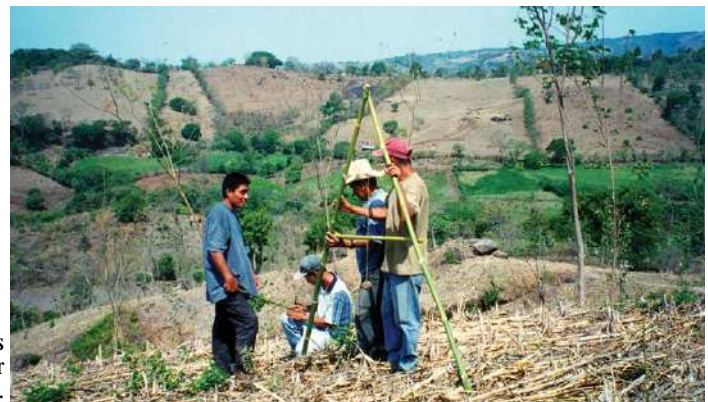
Promotor y productor mostrando a sus erradicados a usar el "Nivel A" para hacer curvas a nivel.
