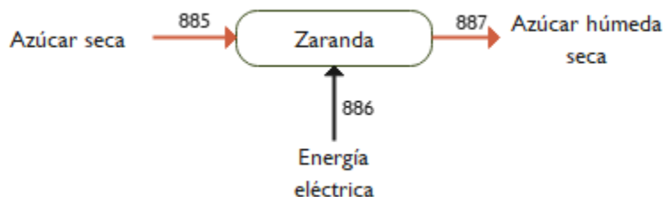
Figura 123. Flujos de entrada y salida de la zaranda Fuente: Elaboración propia
