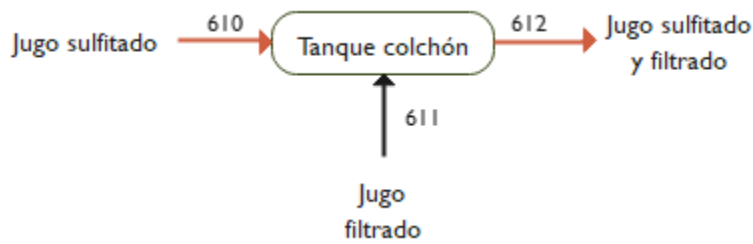
Figura 88. Flujos de entrada y salida del tanque colchón Fuente: Elaboración propia
