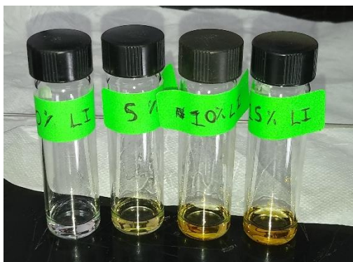
Figura 25. Disolución del [\text{Ch}^+][\text{But}^-] en propanol con cargas de 0, 5, 10 y 15% en peso.
