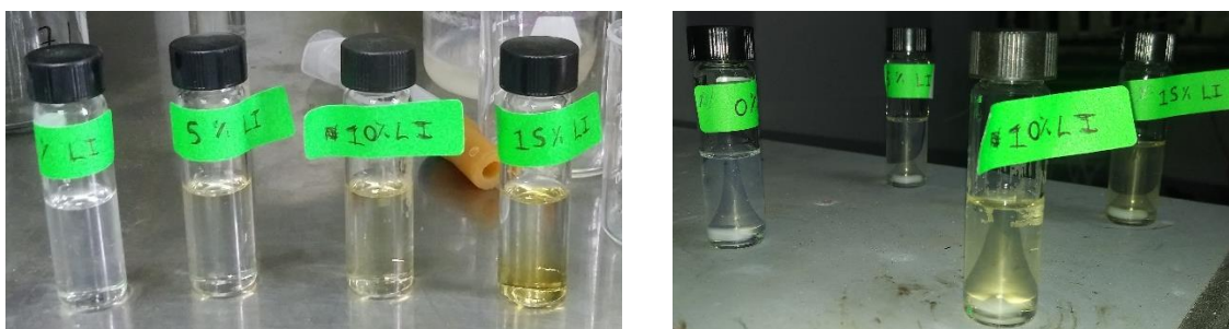
Figura 27. Mezclado homogéneo entre la PEBAX® 2533 y el [\text{Ch}^+][\text{But}^-] usando propanol.
