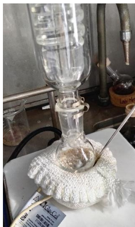
Figura 23. Disolución de la PEBAX® 2533 en propanol con sistema de reflujo y agitación magnética.
