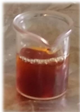
Figura 20. [\text{Ch}^+][\text{But}^-] sintetizado en laboratorio por el método de titulación potenciométrica.
