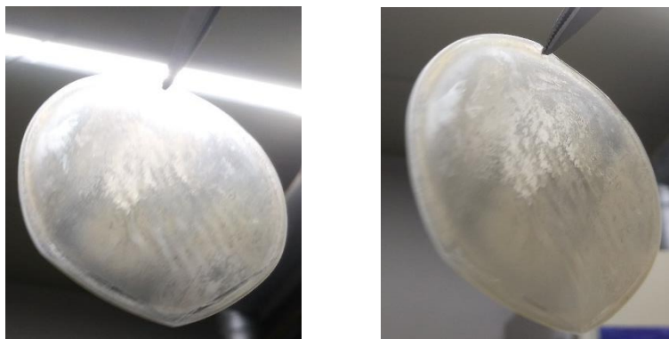
Figura 29. Membranas compuestas con presencia de agua impregnada sobre la superficie.
