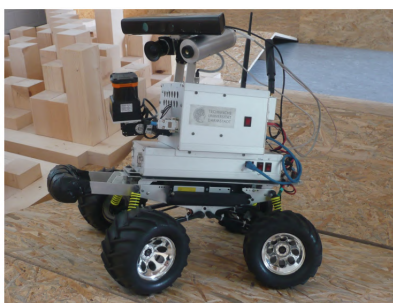
Figura 2.1: Robot Hector utilizado en competencias de Robocup por la Universidad Técnica de Darmstadt. [14]
