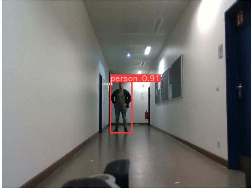
Figura 6.5: Visualización del paquete en ROS para la detección de personas usando YOLO. Este paquete permite la publicación en tiempo real de imágenes, donde se resalta en color rojo la caja delimitadora (bounding box) junto con la probabilidad asociada de 91 % de pertenecer a la clase persona.
