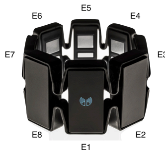
Fig. 3.2.: Sensor Myo armband con sus electrodos categorizados.
