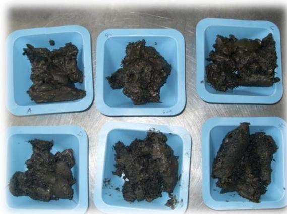
Figura 18. Lodos anaerobios para inocular los reactores anaerobios.
