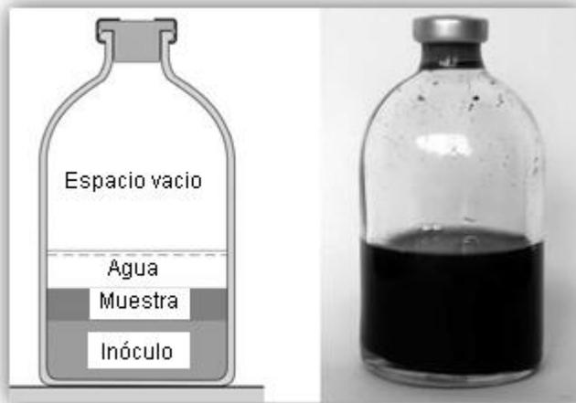
Figura 7. Ensayo en recipientes para la prueba de biodegradabilidad anaerobia
