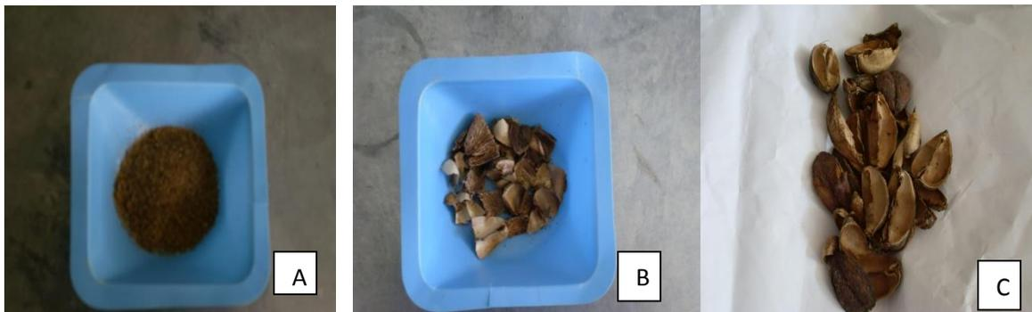
Figura 16. Estado físico de la cáscara de *Jatropha curcas* L (A: cáscara entera, B: cáscara molida, C: cáscara en fragmentos).
