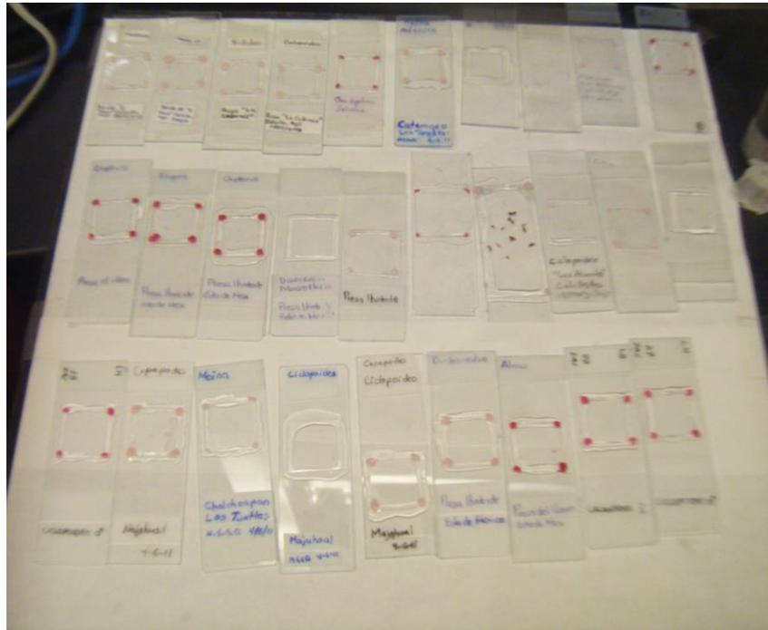
**Figura 9. Laminillas permanentes para identificación realizadas en el laboratorio de UAA.**
