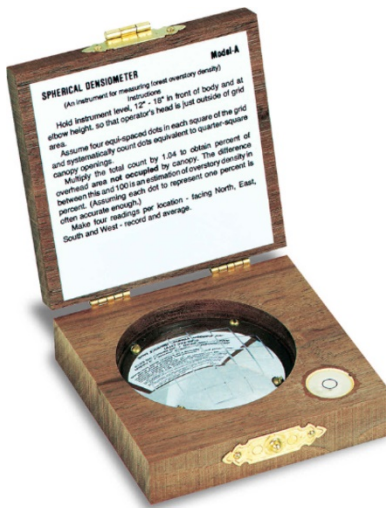
Figura 14. Densiómetro esférico cóncavo (densímetro de corona Forestal) para determinar la cobertura forestal (Gis Ibérica S.L., 2003)
