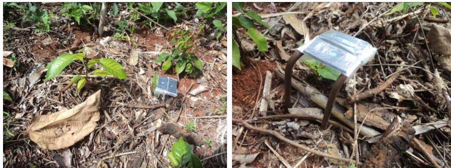
Figura 15. Colocación del paquete de papel diazo sobre estacas cerca de las plántulas de caoba en campo.
