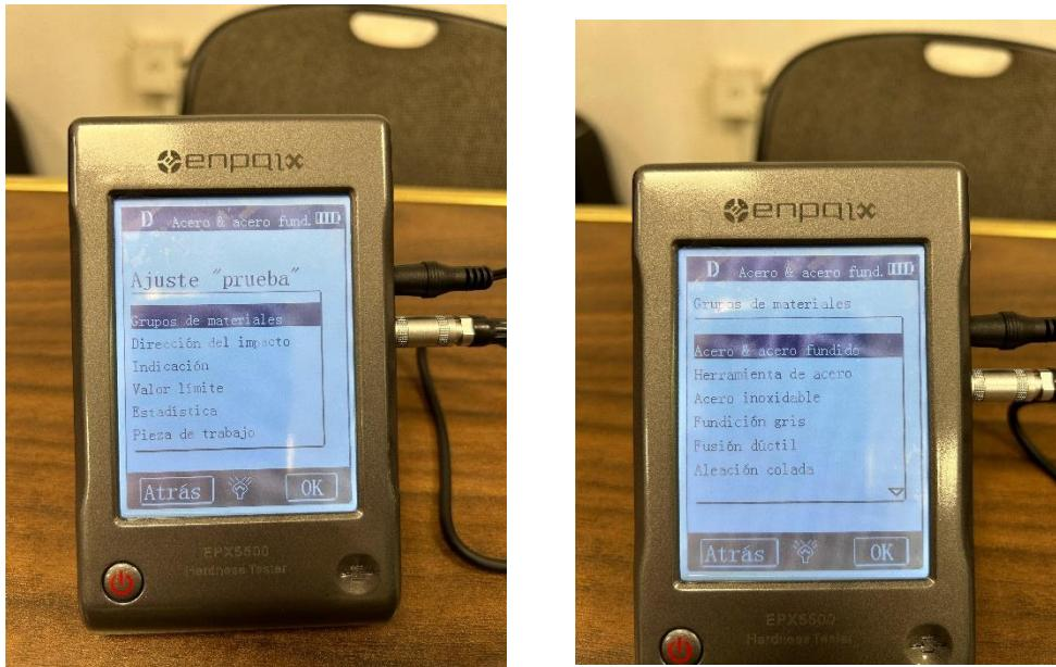
6. Una vez concluido el paso anterior ya estará todo configurado y listo para proceder a hacer las pruebas con un pequeño detalle que a continuación se explicará. Presionaremos el botón ATRÁS hasta llegar a la pantalla inicial del durómetro (será la misma pantalla que apareció cuando se encendió el equipo) una vez ahí viene el pequeño detalle, como se muestra en la imagen donde el lápiz esta apuntando. Tendremos que presionar en ese espacio hasta que tengamos las unidades de HR.
