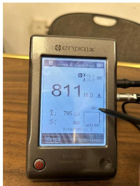
7. A continuación, procederemos a iniciar nuestra prueba de dureza sobre nuestra probeta. De igual forma que hicimos con la calibración, debemos de tomar el lápiz con el identificador y golpear nuestra probeta 5 veces en diferentes zonas cada impacto. Cada golpe nos marcará un resultado, por lo tanto, tendremos 5 resultados que saldrán automáticamente en otra pestaña
