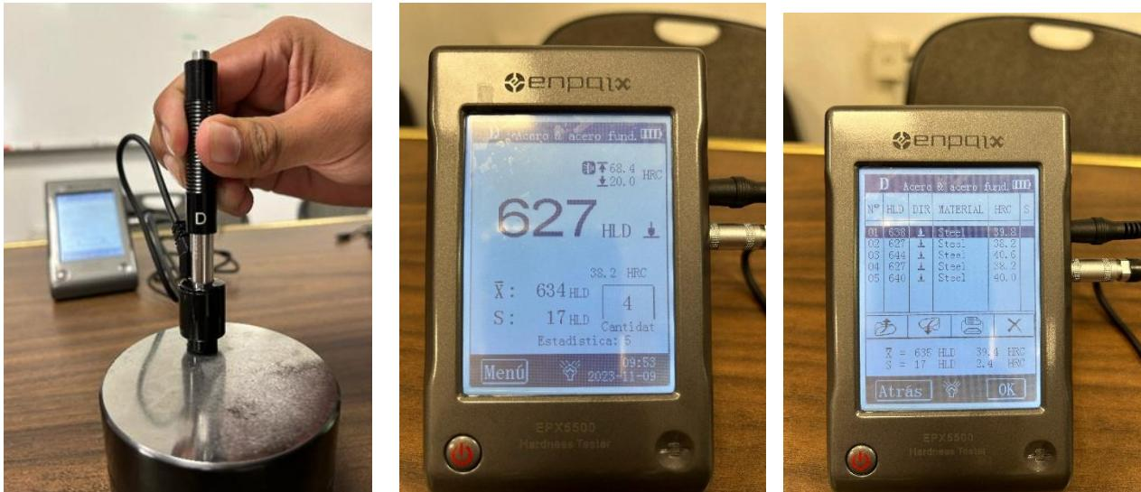
8. Una vez que tenemos los resultados lo ultimo que queda por hacer es imprimir los datos. Para esto encendemos nuestra mini impresora (esta se conectara automáticamente con el durómetro), Seleccionar en la pantalla el dibujo de la impresora y listo tendremos nuestros resultados de dureza.
