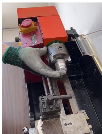
Ilustración 128.- Manufactura de probetas de aluminio.
